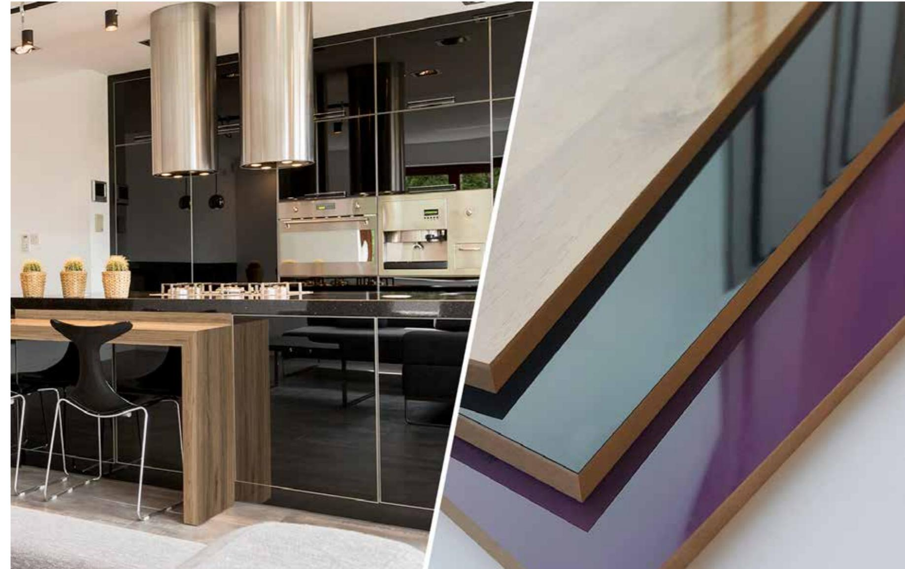
MDFveyayongalehanıñüzeyine tutkalve UVlak uygulanması sonucunda elde edilen dekoratif parlakyüzeyli ahşap panellerdir. Çizilme ve aşınmaya dirençli, diğer parlak yüzeylere göre daha sert bir yüzeye sahiptir. Ayrıca UV ışınlarıla sertleşen üst tabaka, güneş ışığı tarafından solmaya ve kimyasallara karşı dayanımlıdır. Bu sayede mükemmel bir ayna parlaklığı elde edilir.
